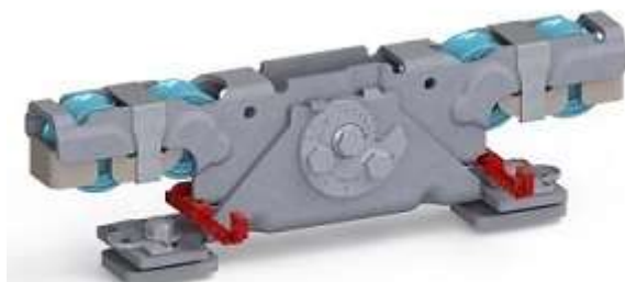
Doppelaufrollentechnologie samt Entgleisungsschutz und Exzentrerschraube zur Höhenangleichung
