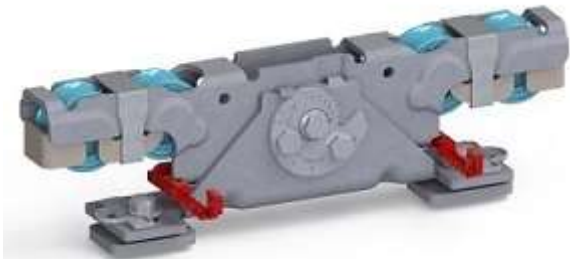
Doppelaufrollentechnologie samt Entgleisungsschutz und Exzenterschraube zur Höhenangleichung
