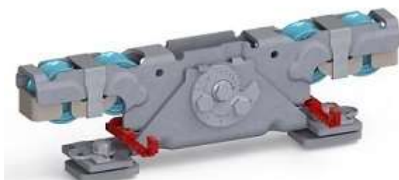
Doppelaufrollentechnologie samt Entgleisungsschutz und Exzentrerschraube zur Höhenangleichung
