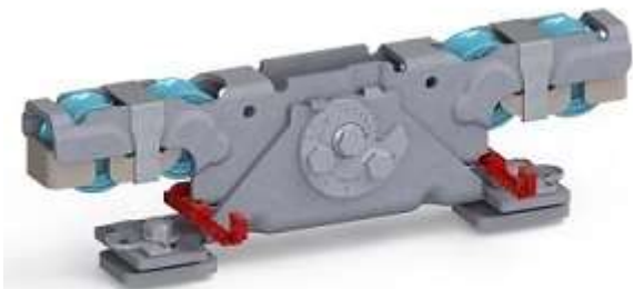
Doppelaufrollentechnologie samt Entgleisungsschutz und Exzenterschraube zur Höhenangleichung
