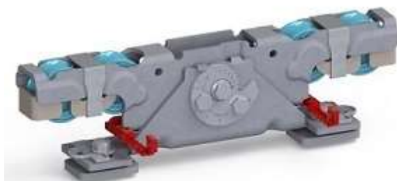
Doppelaufrollentechnologie samt Entgleisungsschutz und Exzenterschraube zur Höhenangleichung
