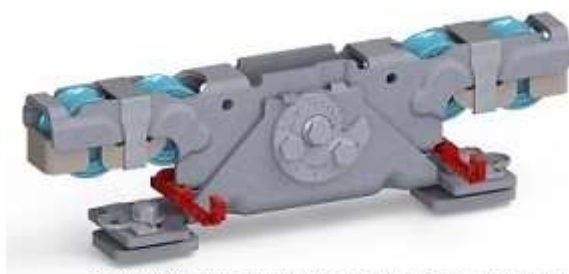
Doppelaufrollentechnologie samt Entgleisungsschutz und Exzenterschraube zur Höhenangleichung
