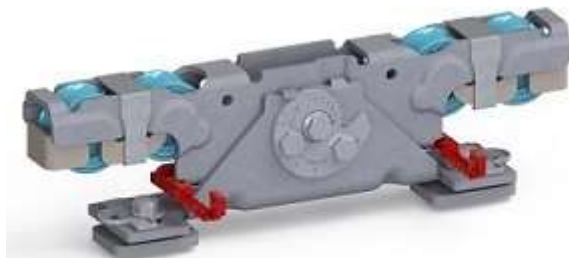
Doppelaufrollentechnologie samt Entgleisungsschutz und Exzenterschraube zur Höhenangleichung
