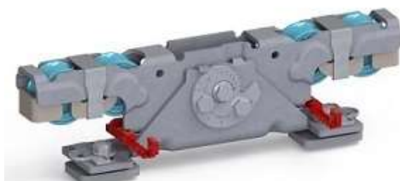
Doppelaufrollentechnologie samt Entgleisungsschutz und Exzenterschraube zur Höhenangleichung
