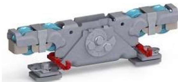
Doppelaufrollentechnologie samt Entgleisungsschutz und Exzentrerschraube zur Höhenangleichung
