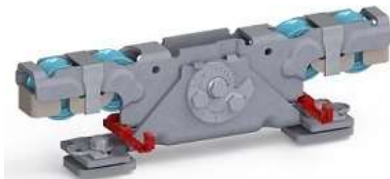
Doppelaufrollentechnologie samt Entgleisungsschutz und Exzentrerschraube zur Höhenangleichung
