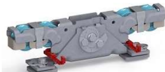
Doppelaufrollentechnologie samt Entgleisungsschutz und Exzentrerschraube zur Höhenangleichung
