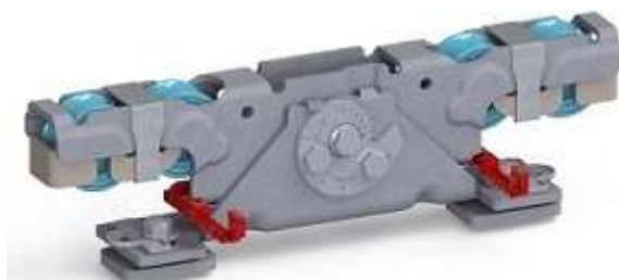
Doppelaufrollentechnologie samt Entgleisungsschutz und Exzenterschraube zur Höhenangleichung
