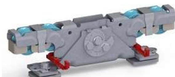
Doppelaufrollentechnologie samt Entgleisungsschutz und Exzentrerschraube zur Höhenangleichung
