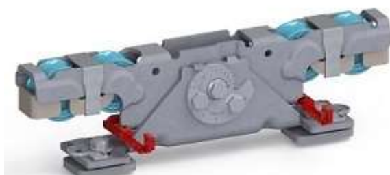
Doppelaufrollentechnologie samt Entgleisungsschutz und Exzentrerschraube zur Höhenangleichung
