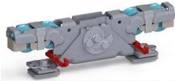
Doppelaufrollentechnologie samt Entgleisungsschutz und Exzentrerschraube zur Höhenangleichung
