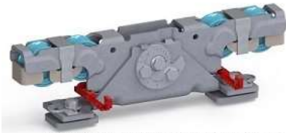
Doppelaufrollentechnologie samt Entgleisungsschutz und Exzentrerschraube zur Höhenangleichung
