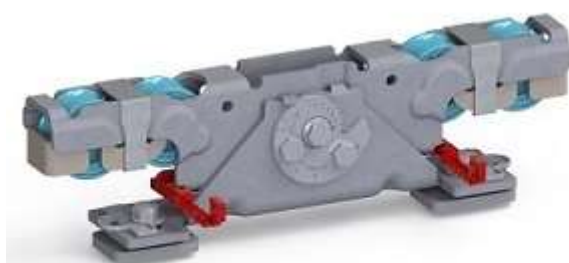
Doppelaufrollentechnologie samt Entgleisungsschutz und Exzenterschraube zur Höhenangleichung
