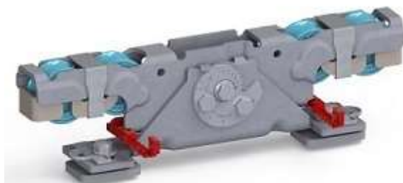
Doppelaufrollentechnologie samt Entgleisungsschutz und Exzenterschraube zur Höhenangleichung
