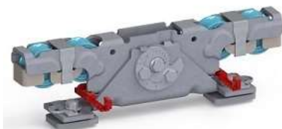
Doppelaufrollentechnologie samt Entgleisungsschutz und Exzenterschraube zur Höhenangleichung
