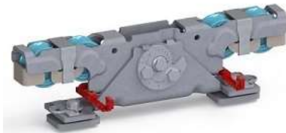
Doppelaufrollentechnologie samt Entgleisungsschutz und Exzentrerschraube zur Höhenangleichung
