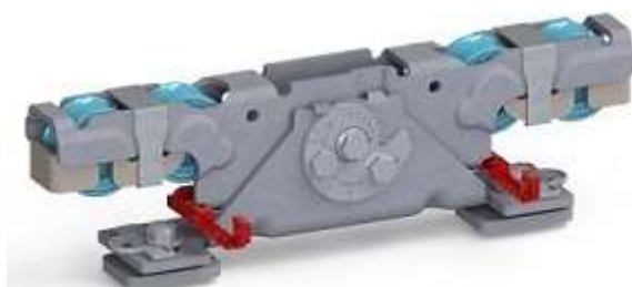
Doppelaufrollentechnologie samt Entgleisungsschutz und Exzenterschraube zur Höhenangleichung
