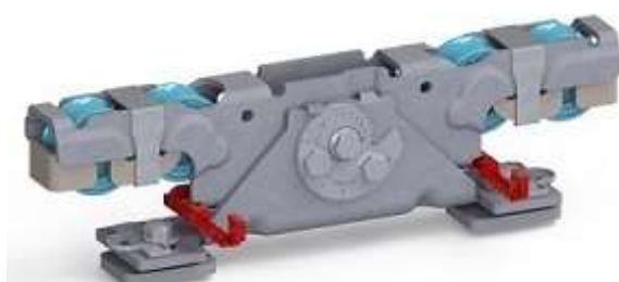
Doppelaufrollentechnologie samt Entgleisungsschutz und Exzenterschraube zur Höhenangleichung
