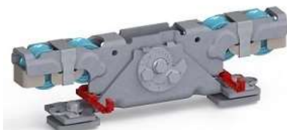
Doppelaufrollentechnologie samt Entgleisungsschutz und Exzenterschraube zur Höhenangleichung
