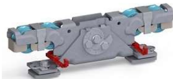
Doppelaufrollentechnologie samt Entgleisungsschutz und Exzenterschraube zur Höhenangleichung
