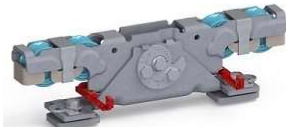
Doppelaufrollentechnologie samt Entgleisungsschutz und Exzenterschraube zur Höhenangleichung
