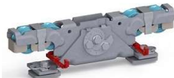
Doppelaufrollentechnologie samt Entgleisungsschutz und Exzenterschraube zur Höhenangleichung
