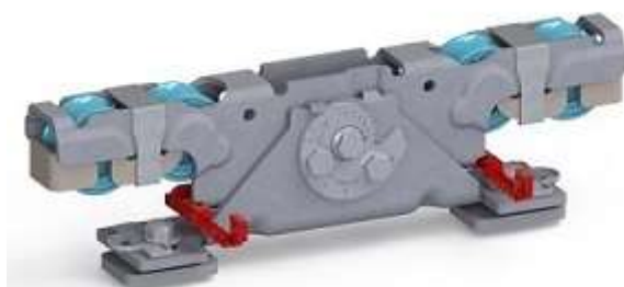
Doppelaufrollentechnologie samt Entgleisungsschutz und Exzenterschraube zur Höhenangleichung
