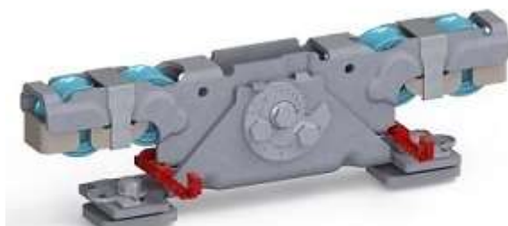
Doppelaufrollentechnologie samt Entgleisungsschutz und Exzenterschraube zur Höhenangleichung
