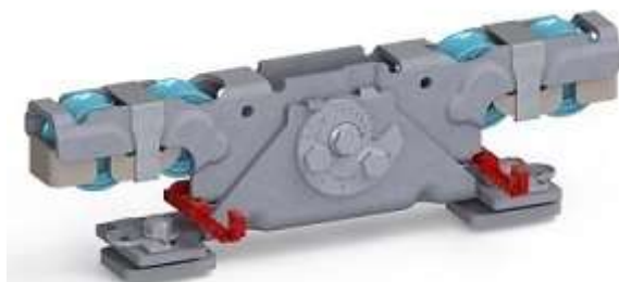
Doppelaufrollentechnologie samt Entgleisungsschutz und Exzenterschraube zur Höhenangleichung
