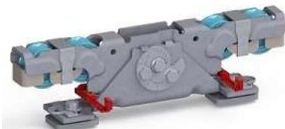
Doppelaufrollentechnologie samt Entgleisungsschutz und Exzenterschraube zur Höhenangleichung
