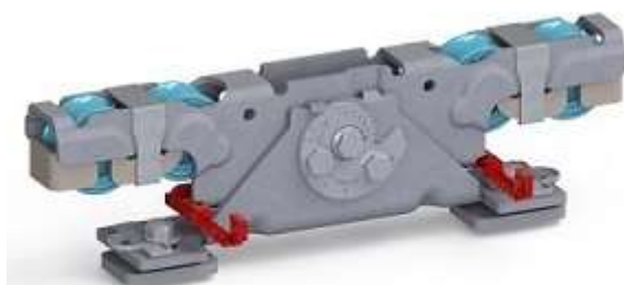
Doppelaufrollentechnologie samt Entgleisungsschutz und Exzenterschraube zur Höhenangleichung
