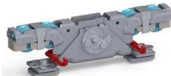
Doppelaufrollentechnologie samt Entgleisungsschutz und Exzenterschraube zur Höhenangleichung
