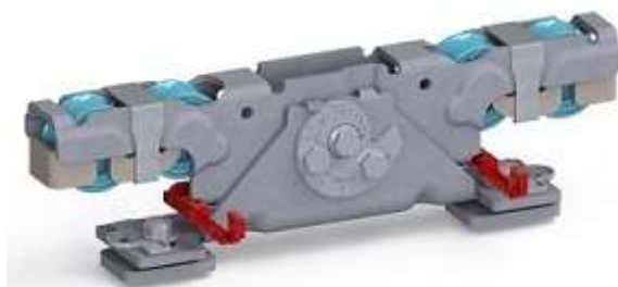
Doppelaufrollentechnologie samt Entgleisungsschutz und Exzenterschraube zur Höhenangleichung
