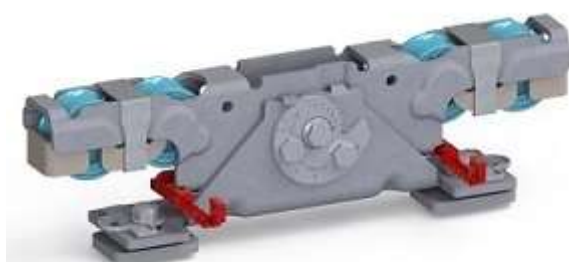
Doppelaufrollentechnologie samt Entgleisungsschutz und Exzenterschraube zur Höhenangleichung
