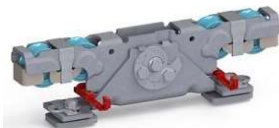
Doppelaufrollentechnologie samt Entgleisungsschutz und Exzenterschraube zur Höhenangleichung
