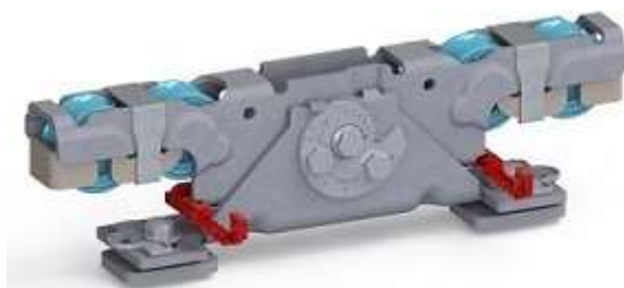
Doppelaufrollentechnologie samt Entgleisungsschutz und Exzenterschraube zur Höhenangleichung
