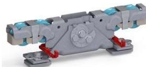
Doppelaufrollentechnologie samt Entgleisungsschutz und Exzenterschraube zur Höhenangleichung
