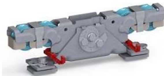
Doppelaufrollentechnologie samt Entgleisungsschutz und Exzenterschraube zur Höhenangleichung
