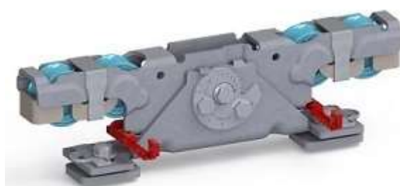
Doppelaufrollentechnologie samt Entgleisungsschutz und Exzenterschraube zur Höhenangleichung
