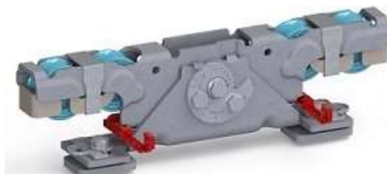
Doppelaufrollentechnologie samt Entgleisungsschutz und Exzeterschraube zur Höhenangleichung
