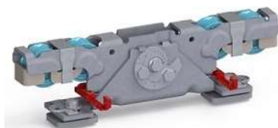
Doppelaufrollentechnologie samt Entgleisungsschutz und Exzentrerschraube zur Höhenangleichung
