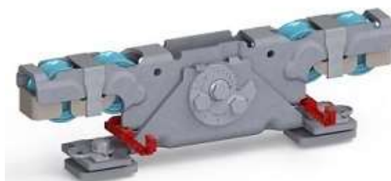
Doppelaufrollentechnologie samt Entgleisungsschutz und Exzentrerschraube zur Höhenanpassung
