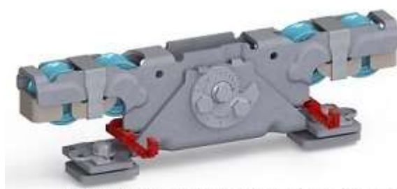
Doppelaufrollentechnologie samt Entgleisungsschutz und Exzenterschraube zur Höhenangleichung
