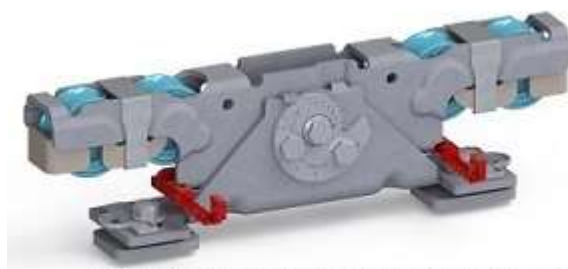
Doppelaufrollentechnologie samt Entgleisungsschutz und Exzentrerschraube zur Höhenangleichung
