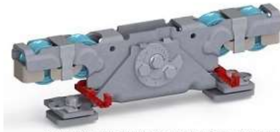
Doppellaufrollentechnologie samt Entgleisungsschutz und Exzenterschraube zur Höhenangleichung
