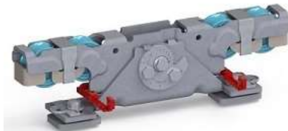
Doppelaufrollentechnologie samt Entgleisungsschutz und Exzenterschraube zur Höhenangleichung
