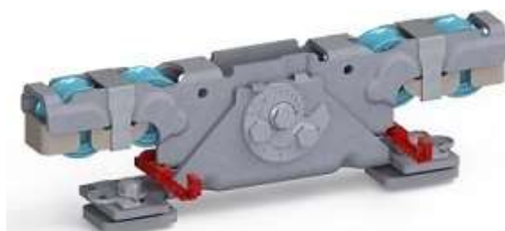
Doppelaufrollentechnologie samt Entgleisungsschutz und Exzentrerschraube zur Höhenangleichung
