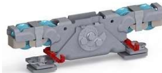
Doppellaufrollentechnologie samt Entgleisungsschutz und Exzentrerschraube zur Höhenangleichung
