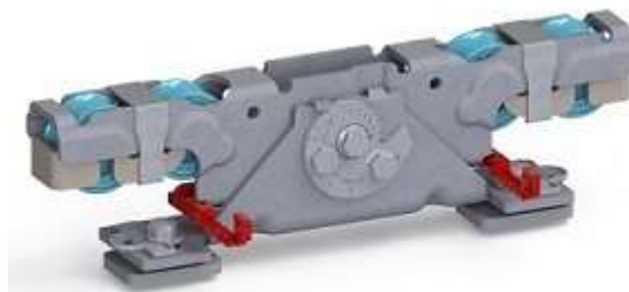
Doppelaufrollentechnologie samt Entgleisungsschutz und Exzenterschraube zur Höhenangleichung
