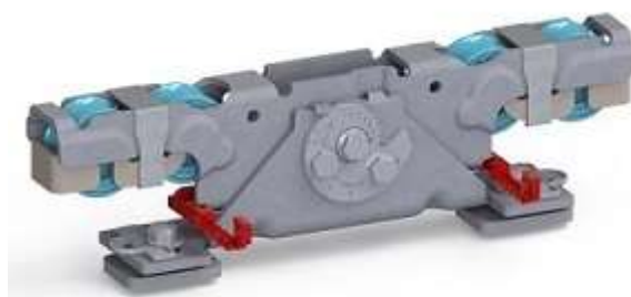
Doppelaufrollentechnologie samt Entgleisungsschutz und Exzenterschraube zur Höhenangleichung
