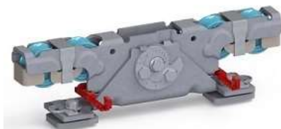
Doppelaufrollentechnologie samt Entgleisungsschutz und Exzenterschraube zur Höhenangleichung
