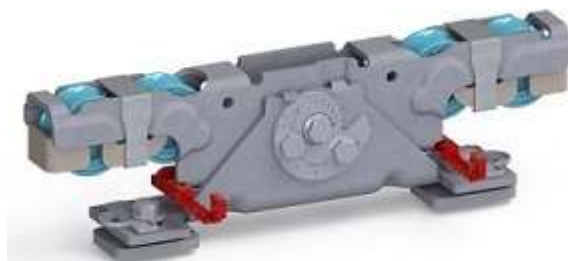
Doppelaufrollentechnologie samt Entgleisungsschutz und Exzenterschraube zur Höhenangleichung
