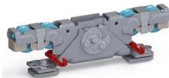
Doppelaufrollentechnologie samt Entgleisungsschutz und Exzentralschraube zur Höhenangleichung
