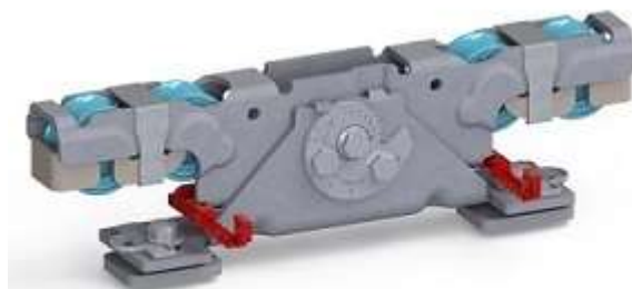
Doppelaufrollentechnologie samt Entgleisungsschutz und Exzenterschraube zur Höhenangleichung
