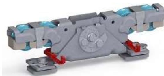
Doppelaufrollentechnologie samt Entgleisungsschutz und Exzenterschraube zur Höhenangleichung
