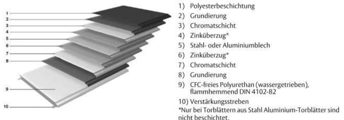
ASSA_ABLOY_OH1042P_Paneelaufbau
