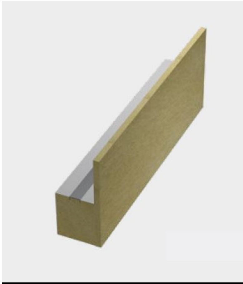
Capatect Schürzenelement MWA plus Schürze aus MW mit Montageschiene und Aufdoppelung auf der Längsseite (vorne)
