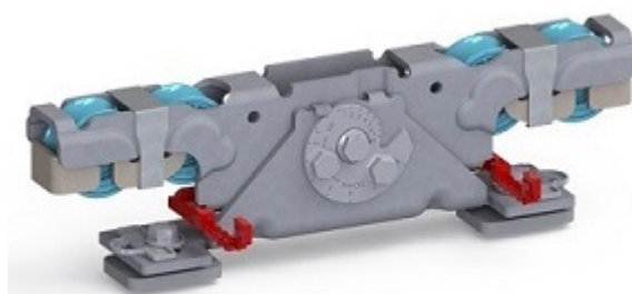
Doppelaufrollentechnologie samt Entgleisungsschutz und Exzenterschraube zur Höhenangleichung
