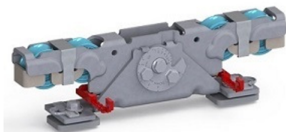
Doppelaufrollentechnologie samt Entgleisungsschutz und Exzenterschraube zur Höhenangleichung
